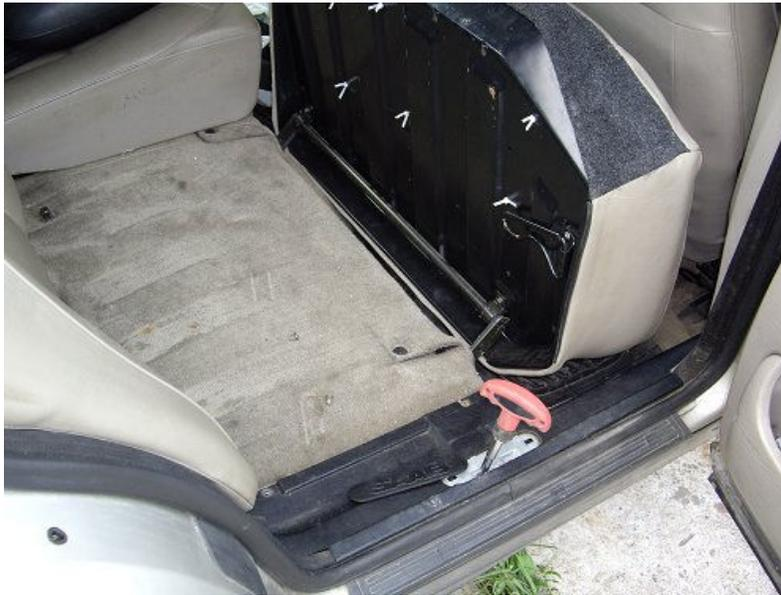
Приподнимаем обивку пола и открываем отверстие, закрытое пенопластовой крышкой. К краю отверстия скобкой крепится контакт датчика. Вытаскиваем его на свет, разъединяем и меряем сопротивление датчика. У рабочего оно должно быть 1.1-1.3 кОма. У неработающего его быть и не должно:
