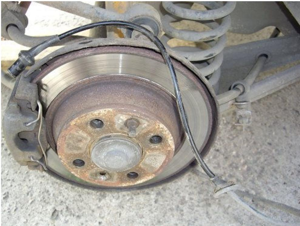
Осталось освободить сам датчик. Как раз для проведения этой процедуры, ради собственной безопасности я бы рекомендовал поставить машину на подпоры. Почти наверняка придется применять силу при вытаскивании датчика и чем прочнее SAAB будет стоять на земле в это время тем лучше.
